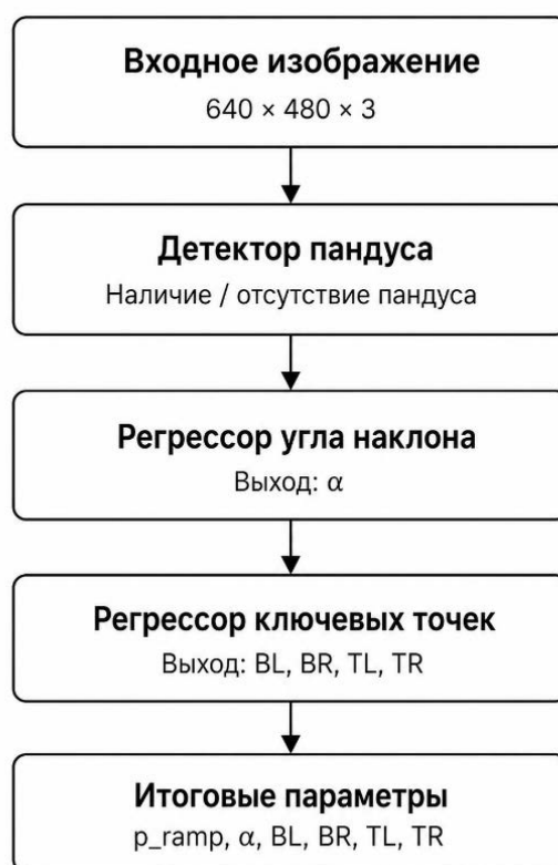
Рисунок 2. Последовательность нейросетевой обработки изображения пандуса
