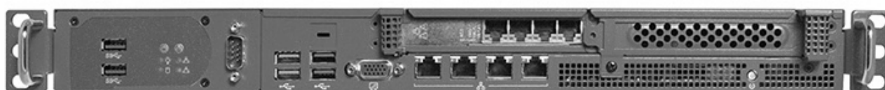
Рисунок 4 – ПАК ViPNet Coordinator HW 1000 C. Источник: [7]
