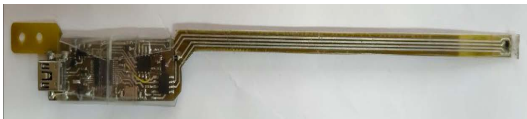
Рисунок 12 – Реальное изображение гауссметра (составлено авторами)
