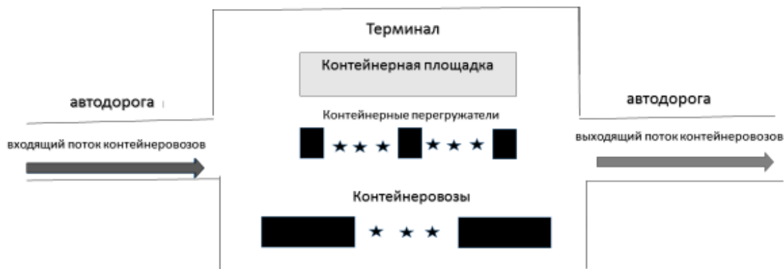
Рис. 1 – Перегрузочный терминал (авторская разработка)
