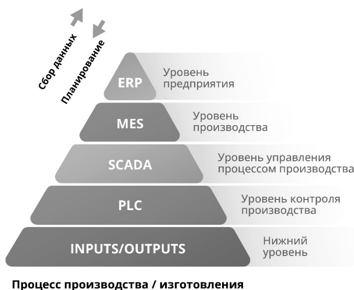
Рис. 1. Иерархическая модель многоуровневых систем управления (адаптировано по стандарту ISA-95).
