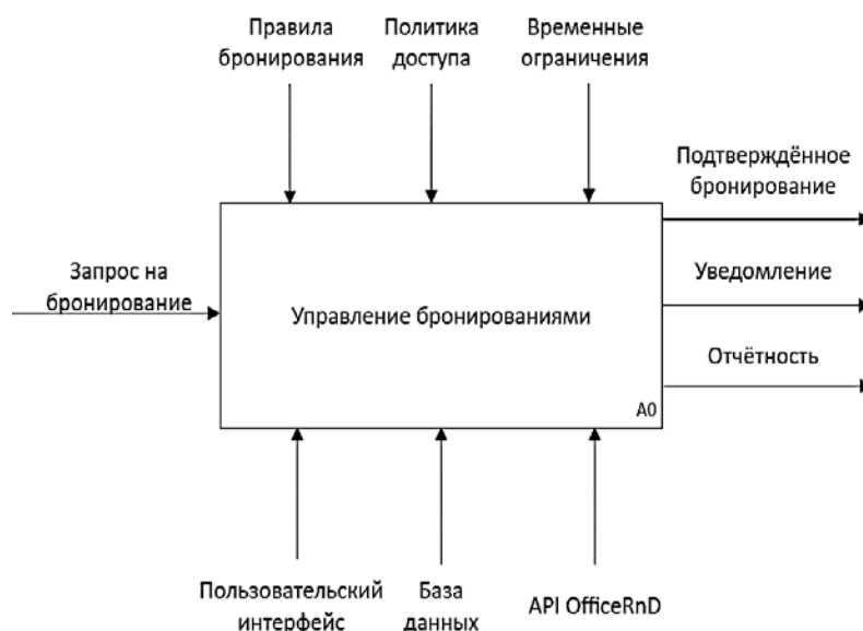
Рисунок 1 – Модель функционирования на уровне А-0 модуля бронирования в составе коворкинг-центра (авторский рисунок)
