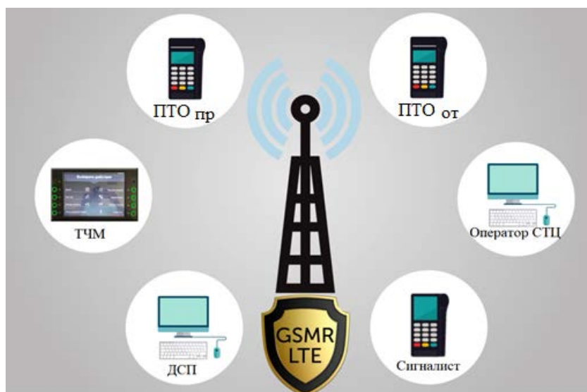
Рис. 2 – Взаимосвязь работников станции посредством цифровой системы радиосвязи (источник [7], редактирование фото автором Соколовым П. А.)
