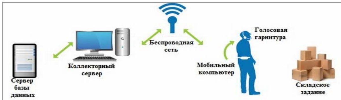
Рисунок 1 – Схема технологии «Pick by voice» при работе на складе 1
