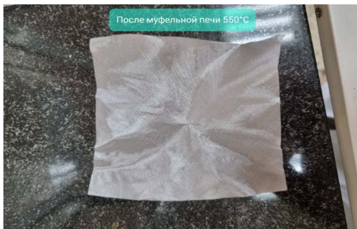
Рис. 5 – Препрег ЭМ-4-1080-63 после муфельной печи Авторская разработка
