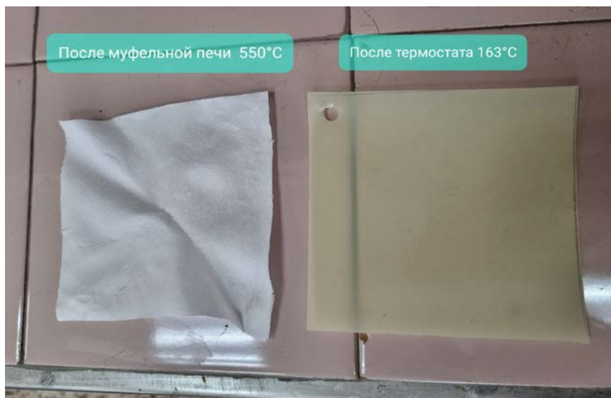
Рис. 3 – Препрег ЭМ-5-1080-63 после испытаний
