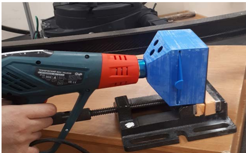
Рис. 8 – образец, зафиксированный в тисках с установленным приспособлением
