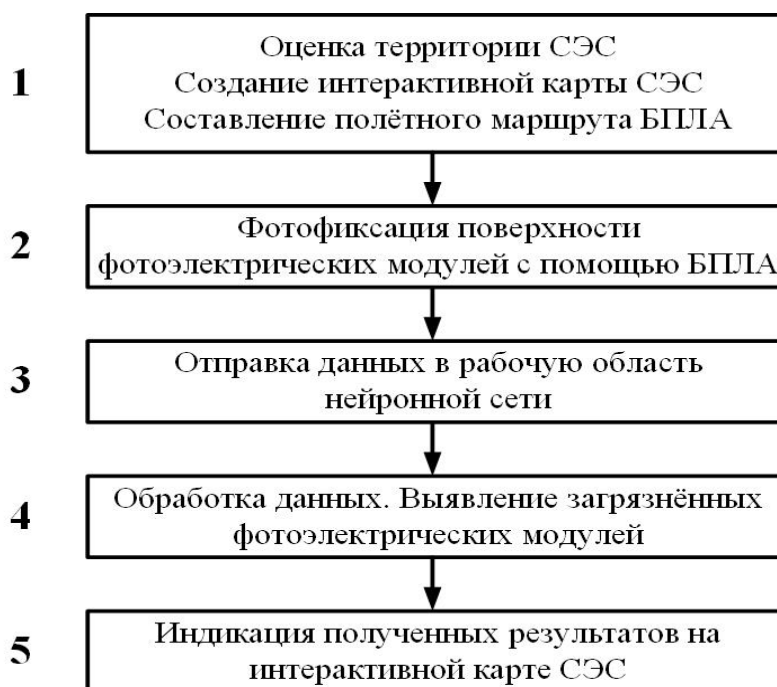
Рис. 1. Функциональная блок-схема, описывающая принцип работы автоматизированного комплекса (авторская разработка)
