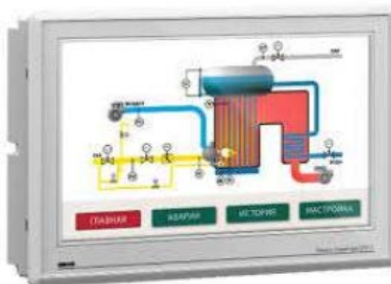
Рис.1 – Внешний вид сенсорной панели оператора ОВЕН СП310 [7]
