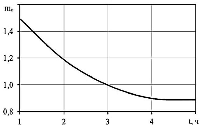
Рис. 3 - Влияние продолжительности технологической приработки на относительное количество эксплуатационных отказов дизелей
