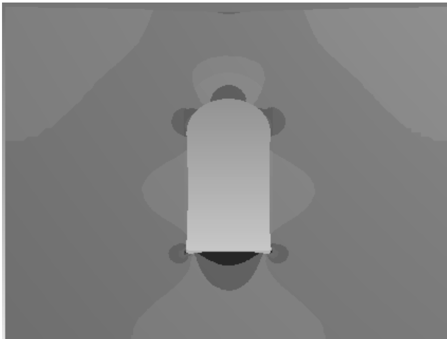
Рисунок 2 – Напряжения \sigma_{33} в исходной геометрической модели
