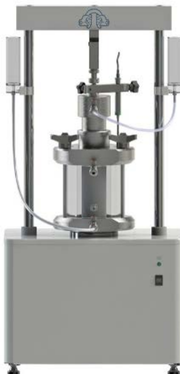
Рис. 5 – Автоматизированный прибор для испытаний дисперсных грунтов методом осесимметричного трехосного сжатия конструкции НПП «Геотек»
