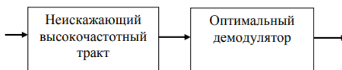
Рисунок 2 - Оптимальный приемник непрерывных сигналов неизвестной формы
