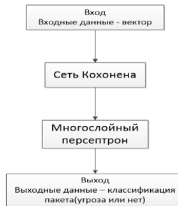
Рисунок 2 – Модель работы гибридной нейросети
