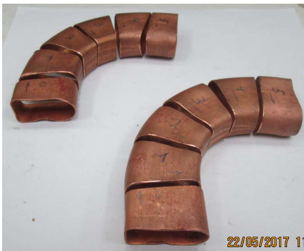
Рис. 3 – Образцы после предварительного деформирования и разрезки
