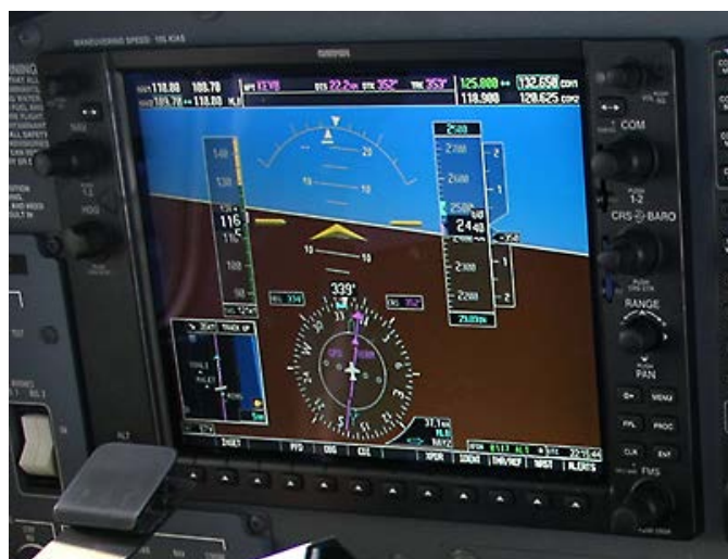
Рис. 5 – Основной пилотажный дисплей пилотажно-навигационного комплекса Garmin-1000 [10]
