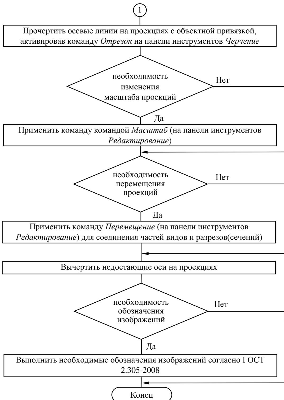
Рис. 1 – Блок-схема процесса алгоритма создания проекционного чертежа 3D-модели в программном продукте NanoCAD. Источник: собственная разработка.
