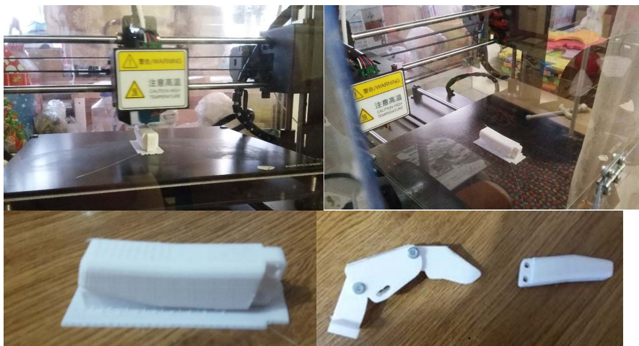
Рисунок 1 – Процесс изготовления элементов протеза на 3D-принтере
