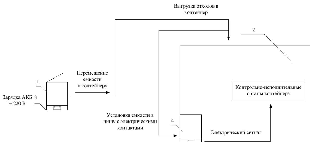
Рис. 1 – Общая схема предлагаемого способа перемещения и предварительной сортировки твердых коммунальных отходов на этапе их складирования в мусорные контейнеры
