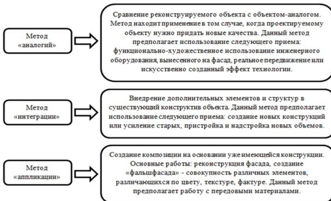
Рис. 1 - Наиболее распространенные методы реконструкции производственных предприятий
