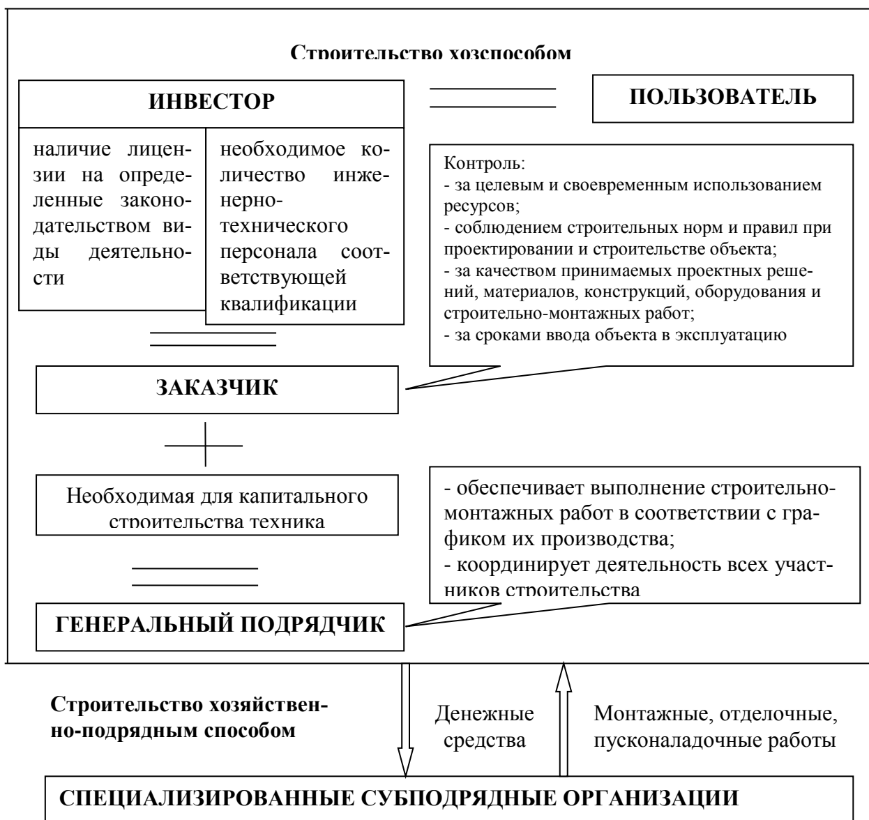
Рис. 2. Схема осуществления строительства хозяйственным и подрядным способом
