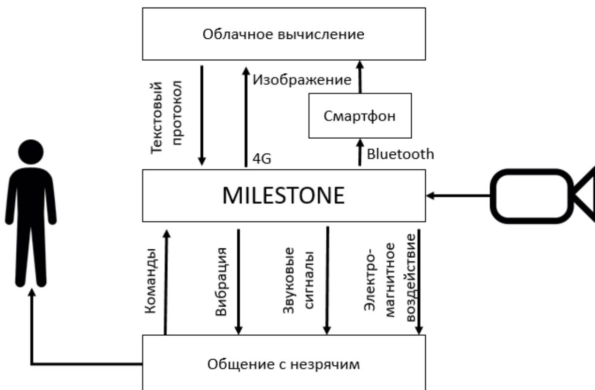
Рисунок 1 – Схема работы сенсорного замещающего устройства
