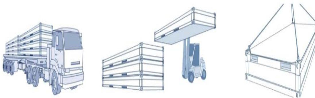
Рисунок 1. Транспортировка и поставка конструкций модульного здания из блок-контейнеров.
