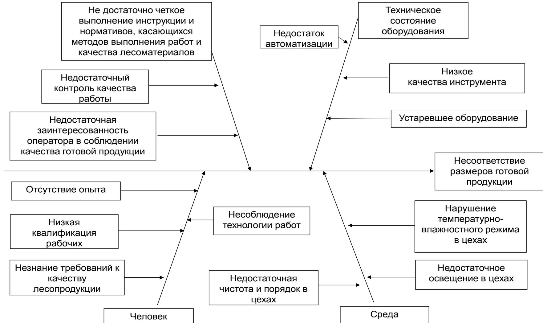
Рисунок 1 – Причинно-следственная диаграмма выявления несоответствия топливных брикетов
