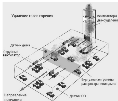
Рисунок 2. Система дымоудаления из автостоянки.
