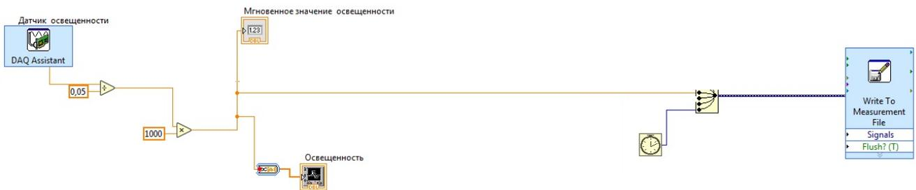
Рис. 1 - Модуль получения, преобразования и вывода на экран и в файл Microsoft Excel данных с датчиков
